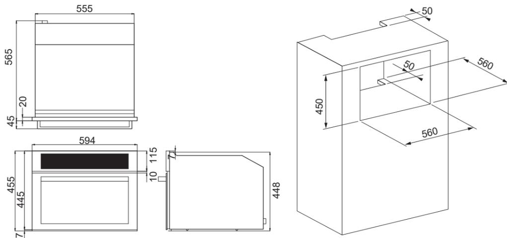
搭配 DD-120 溫杯溫盤機，櫃高預留 585X560X560mm，DD-120 下吃 6mm
