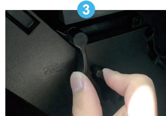
3. 按下核心沖泡器上的左右鎖板撥鈕，聽到「喀喳聲」後，鬆開撥鈕。
