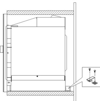
5. 打開門板，用螺絲釘將微波烤箱固定在安裝孔上，然後將裝飾套件塑膠蓋固定到安裝孔上。
