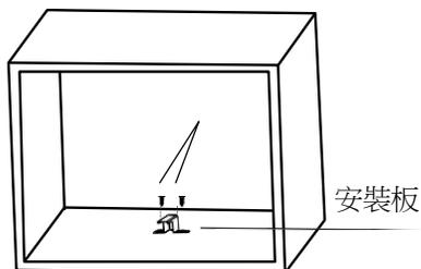
4. 把微波烤箱安裝到櫥櫃，確保微波烤箱背面已用安裝板固定，請勿夾住或扭結電源線。
